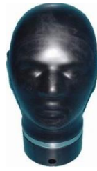
Ideale Kopfform für Maskenprüfungen
