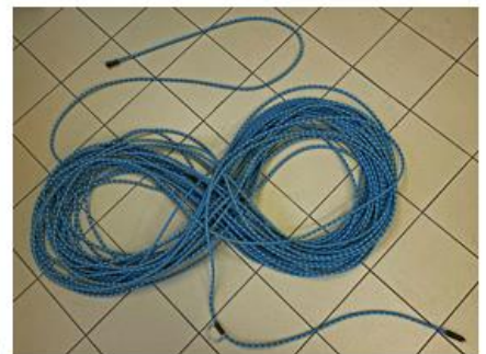
...fertig, Enden für Taucher und Oberflächeneinheit vorbereitet
