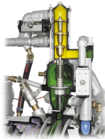
**Es ist jedoch nicht möglich bei Einspeisebetrieb (Direkt in die Pumpe) Schaum zu erzeugen, da durch den Eingangsdruck die Injektor Wirkung gestört wird.**
